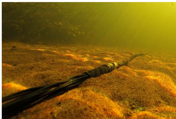
**Рисунок 1.** Электроразведочная коса на дне водоёма.
