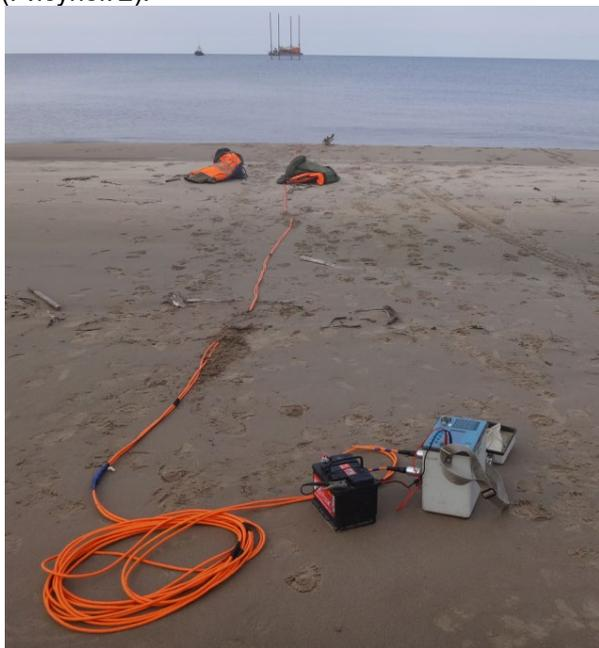
**Рисунок 2.** Электротомография в транзитной зоне.
